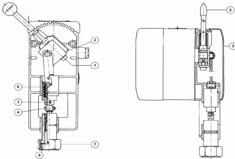
1. На горизонтальный трубопровод электропривод необходимо ставить под углом в промежутке от  $0^{\circ}$  до  $60^{\circ}$  относительно вертикальной оси. Причем чем выше температура регулируемой среды (более  $80^{\circ}\text{C}$ ) угол должен быть больше (макс.  $60^{\circ}$ ) во избежание перегрева привода (см. «Установка на системе»).
